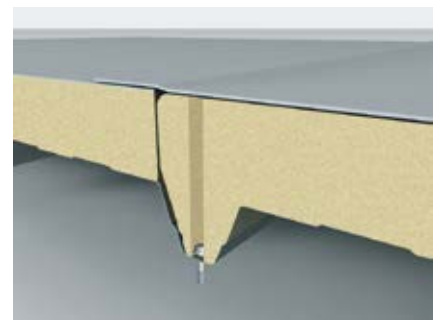
Particolare del giunto Joint detail
