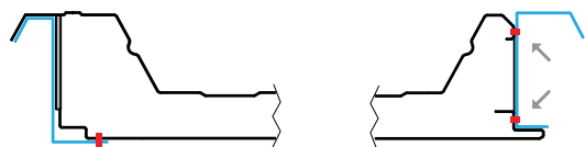
Fissaggio Sottogreca iniziale con rivetto
