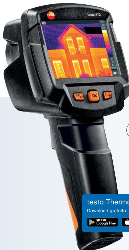
La termocamera testo 872 seduce per le sue caratteristiche ineguagliabili: risoluzione da 320 x 240 pixel, ottima sensibilità termica, numerose funzioni innovative, possibilità di collegamento a uno smartphone tramite la testo Thermography App e il miglior rapporto prezzo-prestazioni della sua categoria.
